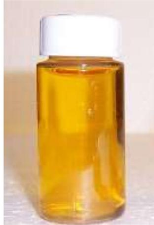
***Il CDS è una soluzione a pH neutro composta da acqua e da due indicatori di pH colorati, uno acido ed uno basico, che determinano un cambiamento di colore del CDS se il pH di questa soluzione scende sotto 4.5 o supera 8.5 in presenza sostanza chimica in esame***
